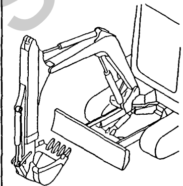
Fig. 52 バケットシリンダ (テレスコピックアーム) BUCKET CYLINDER (TELESCOPIC ARM)
