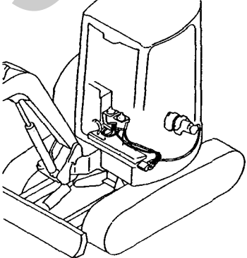
Fig.100 コントロール配管(ポンプ ～バルブ～リターン)(旧形) CONTROL PIPING(PUMP VALVE～RETURN)(PREVIOUS)
