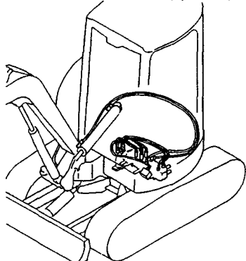
Fig. 90 油圧配管(バルブ～スィベル, スイング)(新形) HYD. OIL PIPING(VAIVE ～SWIVEL, SWING)(NEW)
